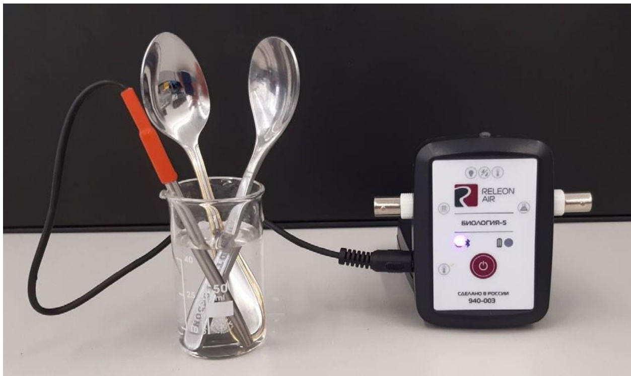
Рис. 2. Измерение температуры в первом стакане горячей водой
