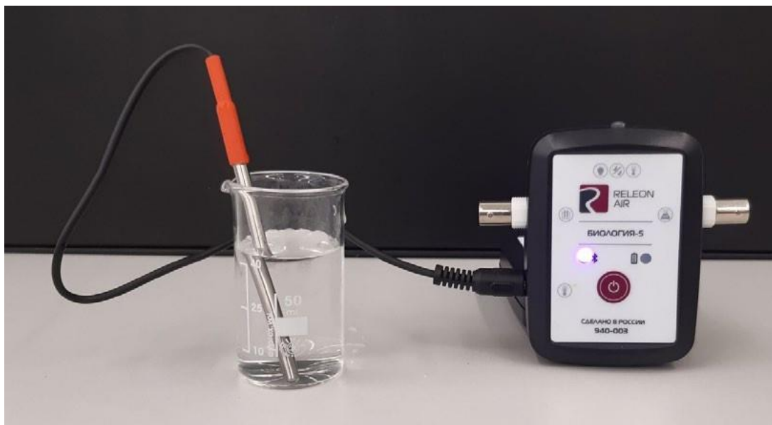
Рис. 1. Измерение температуры в первом стакане горячей водой
