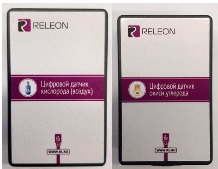
Рис.11. Датчик кислорода (слева) и угарного газа (справа)
