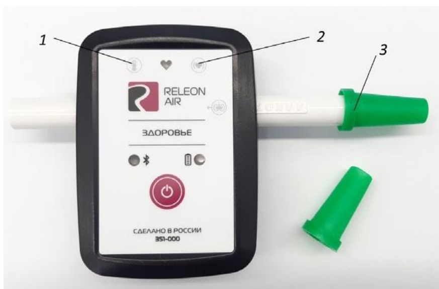
Рис.3. Мультидатчик по физиологии: 1—температура тела, 2—пульс, 3—частота дыхания (надеть съёмный мундштук)
